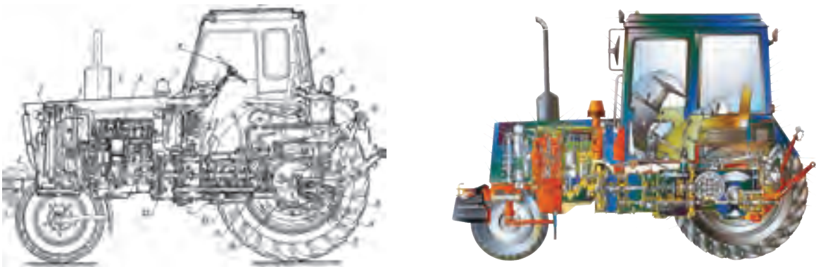
8-rasm. MTZ-80 g‘ildirakli universal chopiq traktorining asosiy qismlari, ularning mexanizmlari va detallarining joylashishi: 1 – boshqariluvchi g‘ildirak; 2 – oldingi ko‘prik; 3 – rul boshqarmasi; 4 – suv; 5 – shovqin so‘ndirgich; 6 – dvigatel; 7 – havo tozalagich; 8 – rul chambaragi; 9 – kabina; 10 – o‘rindiq; 11 – orqa fara; 12 – akkumulatorlar batareyasi; 13 – gidravlik osma tizimining asosiy kuch silindri; 14 – osish mexanizmi; 15 – orqa quvvat olish vali; 16 – taqish qurilmasi; 17 – yetakchi g‘ildirak; 18 – oxirgi uzatma; 19 – differensial; 20 – bosh uzatma; 21 – uzatmalar qutisi; 22 – ilashish muftasi.
