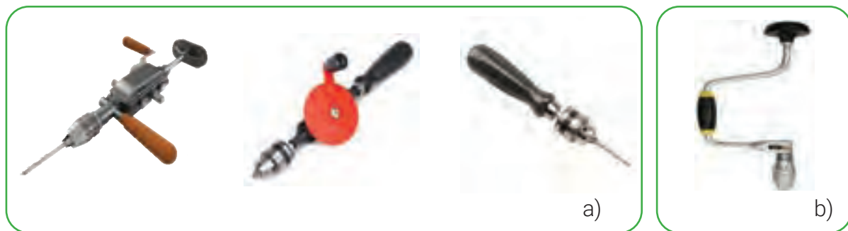
16-rasm. Qo'l (dastaki) drel i turlari: a) dastaki drellar; b) kolovorot.
