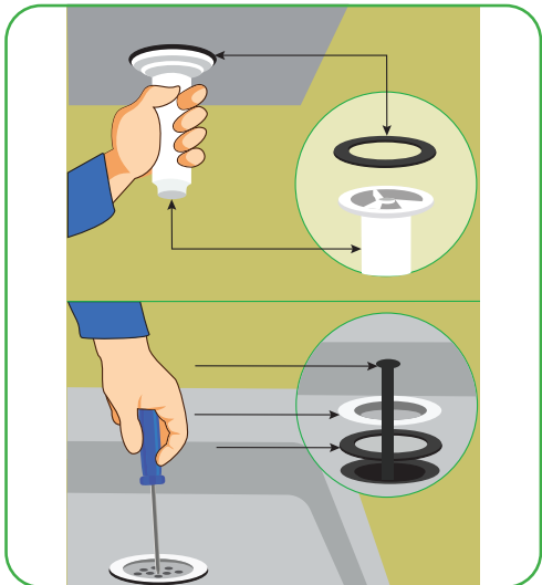
62-rasm. Sifonni o'rnatish: 1 – tiqin; 2 – bo'shatish bolti va setkasi; 3 – idishdan toshgan suv quvuri; 4 – idish (rakovina); 5 – chiqindi suv bo'shlig'i; 6 – kanalizatsiya quvuri; 7 – sifon.
