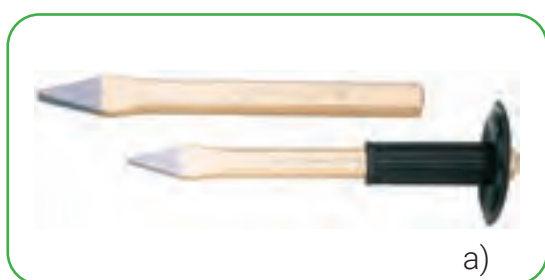
36-rasm. Zubilo va kreysmeysel: a) zubilo; b) kreysmeysel.
