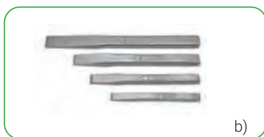
36-rasm. Zubilo va kreysmeysel: a) zubilo; b) kreysmeysel.
